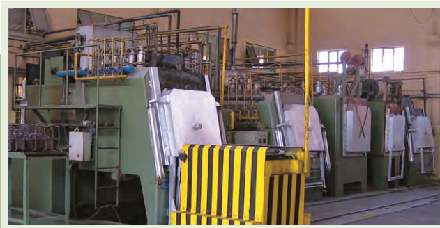
图二 批次式整体淬火炉(照片由Ipsen提供)
