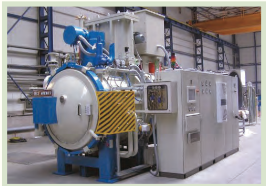
图四 真空炉典型的生产 (照片由SECO/WARWICK公司提供)
