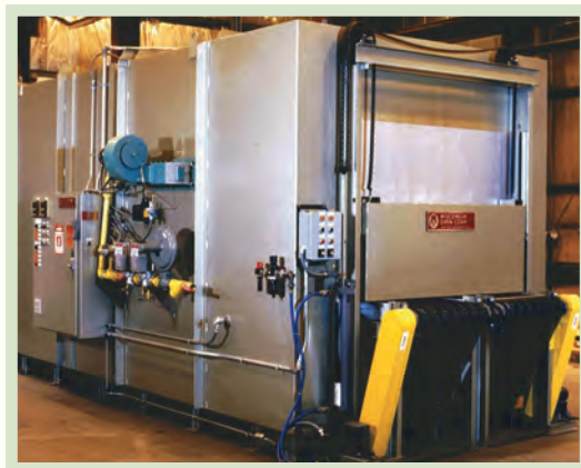
图五 用于紧固件热处理 的典型连续炉 (照片由威斯康 星炉公司提供)
