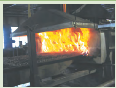
图一 紧固件生产作业量进入火炉进行表面硬化的典型状况
