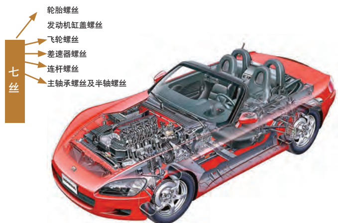
图1 宝钢汽车用的冷镦盘条主要用于汽车螺丝中的「七丝」
