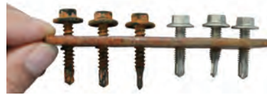
▲ 图9 腐蚀72小时后，澳洲的涂层钉螺纹外径已经从5.41腐蚀到4.1mm，SUS410螺钉尺寸几无变化。
