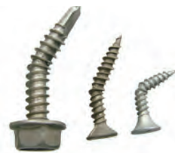
▲ 图8 SUS410螺钉热处理后优良的机械韧性
