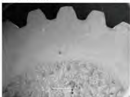
图4 断裂起始侧低倍特征 ×5.5
