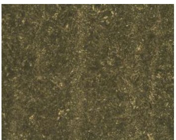
图5、表面回火托氏体+未溶铁素体，500X
