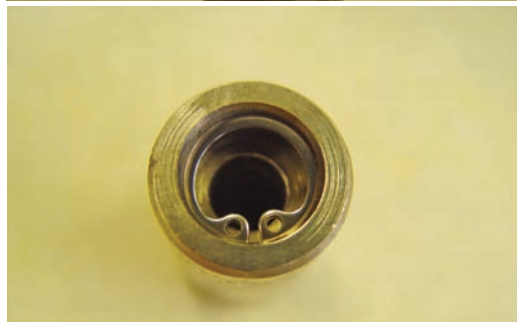
图2 有特殊端点的钳具使用轴向挡圈的含孔洞把手来将之安装于沟槽中。
