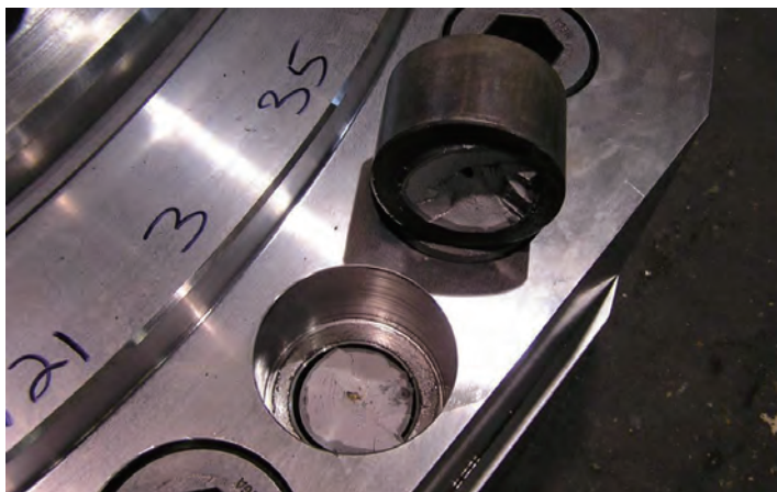
因氢脆而断裂的内六角帽螺丝(图片提供: SV Brahimi)
